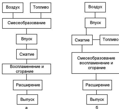
Рисунок 3.1 – Схемы рабочего цикла двигателей
